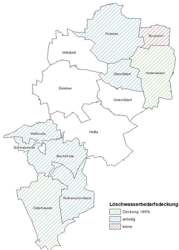
Abbildung 7 Erweiterte Löschwasserbedarfsdeckung über die öffentliche Trinkwasserversorgung und Löschwasserreservoir
