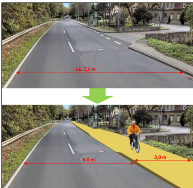
Abb. 100 Magdeburger Straße Bereich Oberhütte: Bau eines Geh- und Radwegs durch Normalisierung der Fahrbahnbreite und barrierefreier Ausbau der Haltestelle
