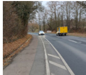
Abb. 41 Radweg an der Magdeburger Straße: wechselnde Qualitäten, ungesicherte Querung, ungenügende Wegbreiten, mangelhafte Wegweisung
